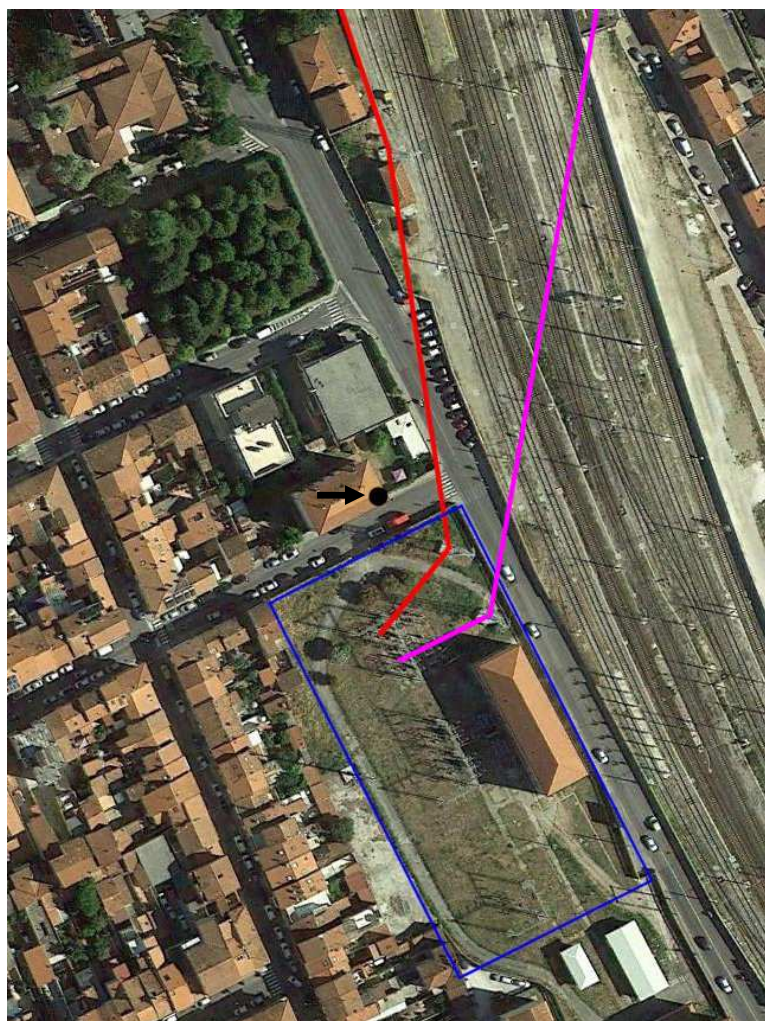
Foto 1: immagine aerea della zona d'indagine. Sono stati evidenziati: la sottostazione elettrica (in blu); il tracciato della linea n. FI596 (in rosso) il tracciato della linea n. FI1013 (in magenta) ed il punto di misura in continua (in nero).
