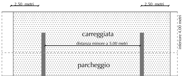
figura 23 attraversamenti multipli del parcheggio e della carreggiata
